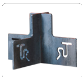
Базовый комплект оснастки для сварки контрольных швов — тавровый шов, стыковое соединение
