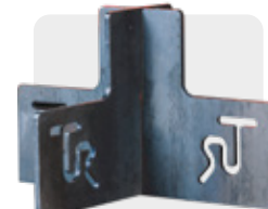
Базовый комплект оснастки для сварки контрольных швов. Тавровый шов, стыковое соединение
