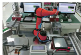
Проверка монтажных плат
